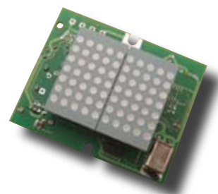
• PK96 точечный дисплей, SSL последовательный ввод
