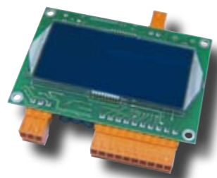
• VM-LCD – переговорное устройство и ЖКИ-дисплей (SSL или двоичный ввод)
