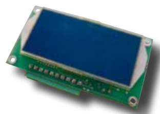
• PK-LCD – двойной 7-сегментный ЖКИ-дисплей и сигнал перегрузки кабины, двоичный ввод
